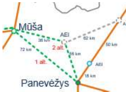
11 pav. 330 kV EPL Panevėžys-Mūša alternatyvų sujungimo schemas ir nagrinėjamos trasos
