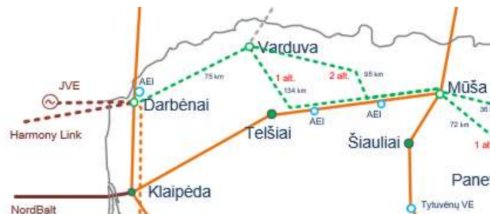
10 pav. 330 kV EPL Darbėnai-Varduva-Mūša sujungimo schema (2 alternatyva)
